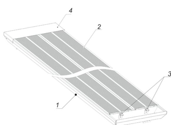
Несущая конструкция состоит из корпуса, а также из крышек и алюминиевых излучающих панелей.
