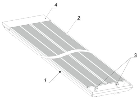
Несущая конструкция состоит из корпуса, а также из крышек и алюминиевых излучающих панелей.
